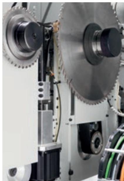
Моторизованный подъем пилы гарантирует **точную и быструю регулировку** вылета пилы.
