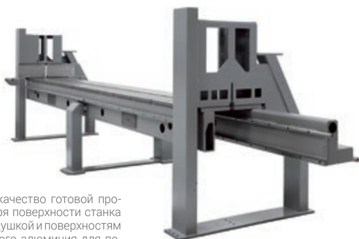
Максимальное качество готовой продукции благодаря поверхности станка с воздушной подушкой и поверхностям из анодированного алюминия для перемещения деликатных материалов. Кроме того, данная характеристика позволяет поддерживать постоянную чистоту поверхности рядом с пилой.
