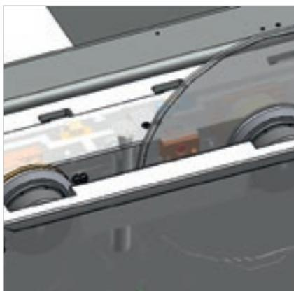
Устройство защиты от перегрузки проверяет положение и скорость вращения пилы, воздействуя на скорость её подачи. Максимальное качество раскроя, увеличенный срок службы пилы и сокращение стоимости обслуживания.
