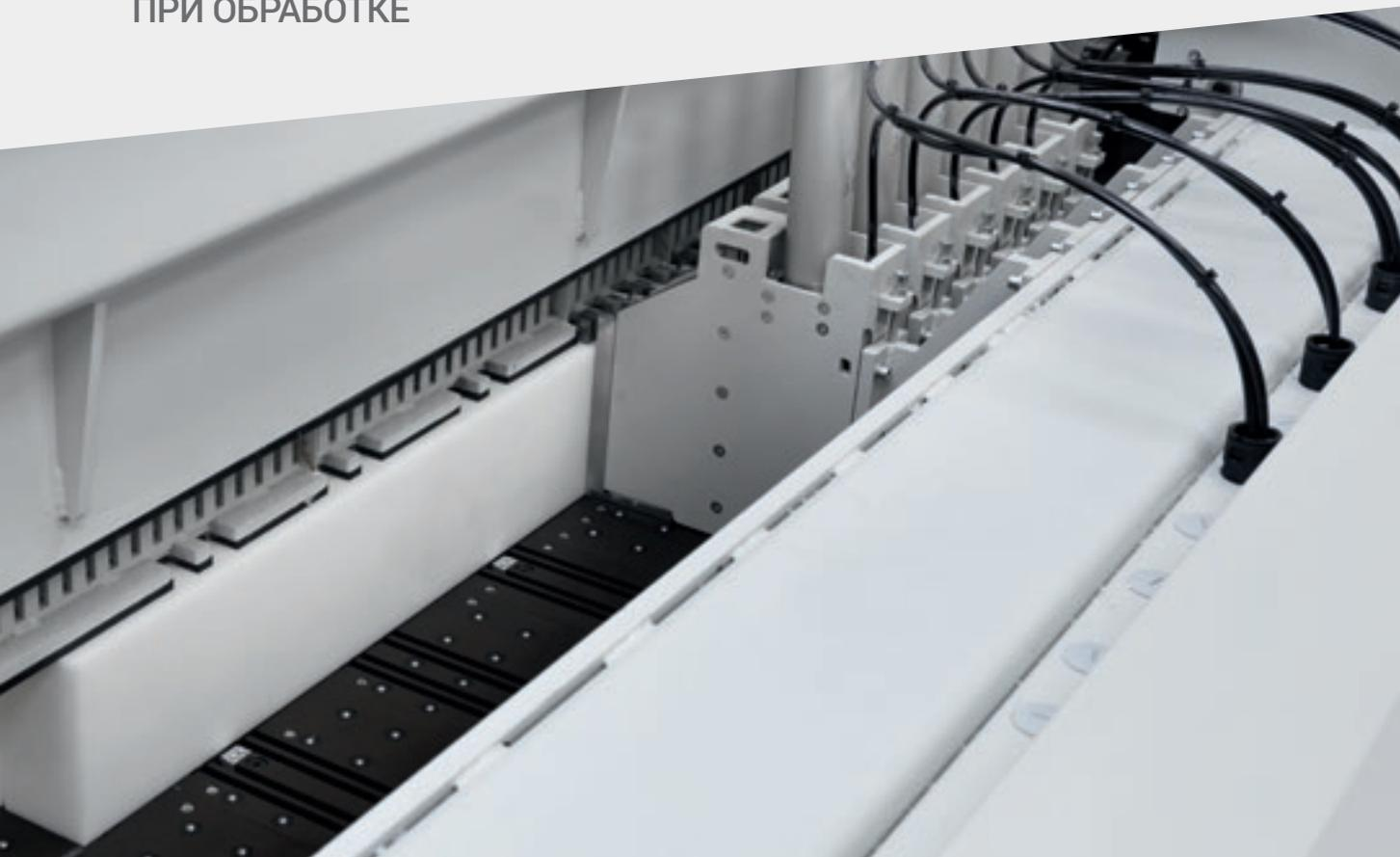
Двойной прижим имеет сдвоенную независимую конструкцию, которая обеспечивает равномерное и контролируемое давление на пакет раскраиваемых панелей благодаря отсутствию отверстий для прохождения зажимов, с созданием настоящей герметичной камеры при раскрое кромки с обеспечением эффективной вытяжки пыли.
