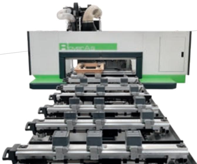
Портальная конструкция Rover AS 15 разработана чтобы выдерживать высокие рабочие нагрузки, сохраняя качество готового изделия.
