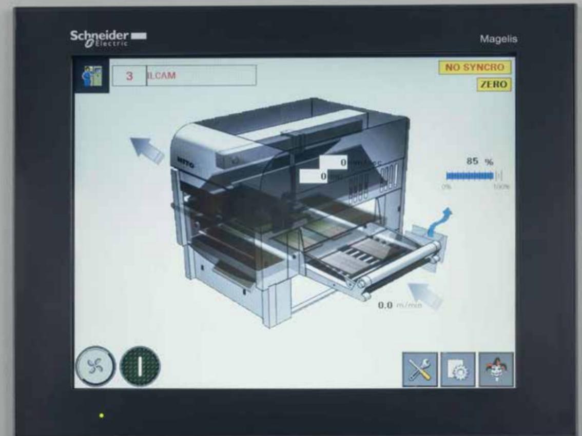
Quadro elettrico di controllo con PLC e software di gestione macchina, comandati da touch screen a colori 12,1".
