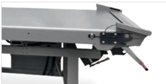
Всасывающий коллектор расположен в конце ленточного транспортера.
