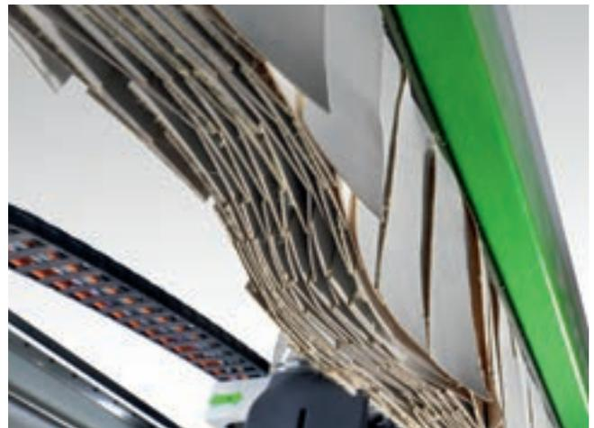
22 наложенных друг на друга слоя боковых защитных шторок для защиты рабочего блока, которые являются подвижными, что позволяет машине работать на максимальной скорости в полной безопасности
