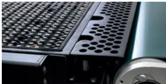
Система вытяжки стружки между станком и ленточным транспортером выгрузки, обеспечивает максимальную очистку деталей.
