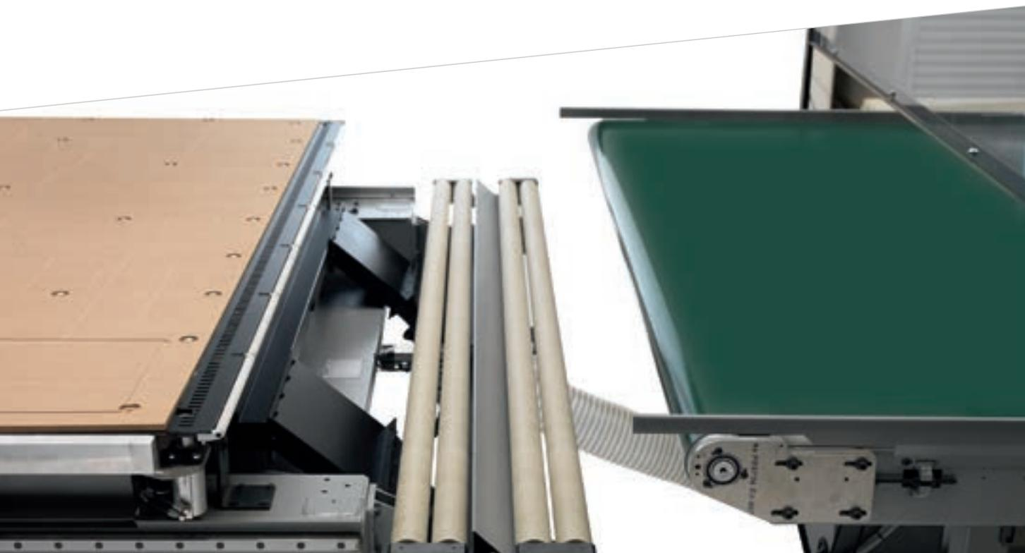
Роликовое прижимное устройство позволяет обрабатывать несколько наложенных друг на друга панелей из воздухопроницаемого материала – до 3-х панелей из необработанной ДСП толщиной 18 мм.
