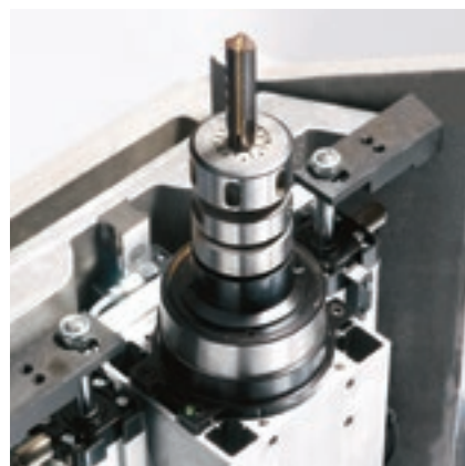
Электрошпиндели с креплением HSK D-50.
