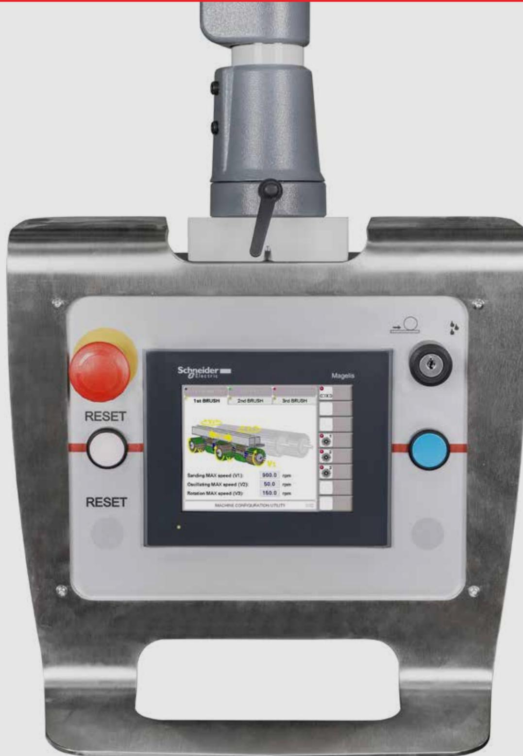
La consolle di comando è dotata di monitor touch screen che permette di avere immediatamente sotto controllo tutti i parametri di lavoro. E' infatti possibile regolare le velocità di lavoro delle spazzole e del trasporto.
