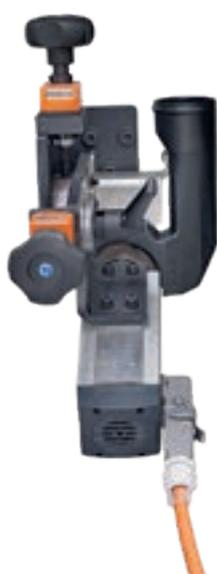
**Кромкообрезная группа** снимает излишки кромки в верхней и нижней частях панели.
