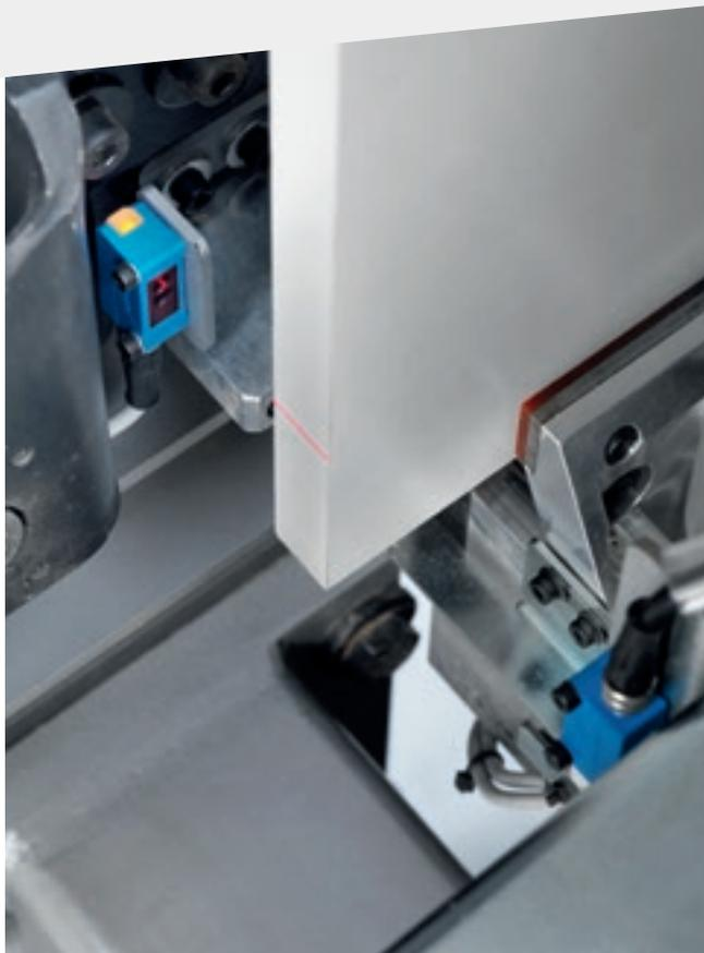
Система **лазерного считывания** служит для считывания начала и конца панели, что позволяет станку компенсировать размерные ошибки с коррекцией координат панели по X.
