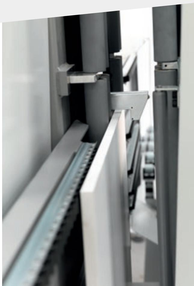
Система **верхнего считывания** имеет пару фотоэлементов, способных считывать высоту панели с целью производить коррекцию размеров по оси "Y".
