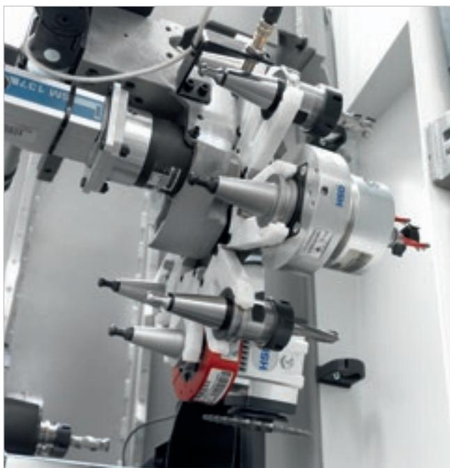
**Магазин на 8 позиций** позволяет размещать различные системы агрегатов, способных увеличивать гибкость станка.
