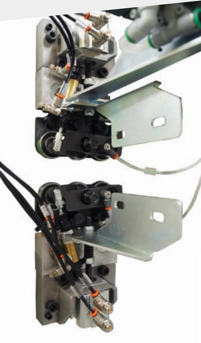
Щёточная группа для очистки и полировки кромки и панели.
