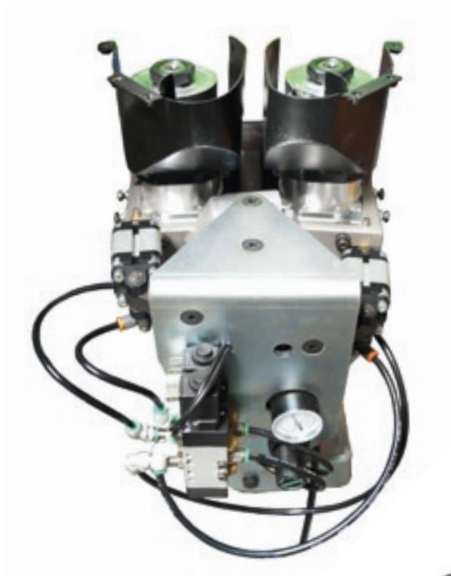
Оптимальное наклеивание благодаря контролю температуры, дифференцированному между клеевой ванной и клеевым роликом. Автоматическое устройство предотвращает перегрев клея, когда станок не используется. Лёгкое и быстрое техническое обслуживание благодаря внутреннему покрытию тефлоном. Устройство автоматической резки для кромки 3 мм.
