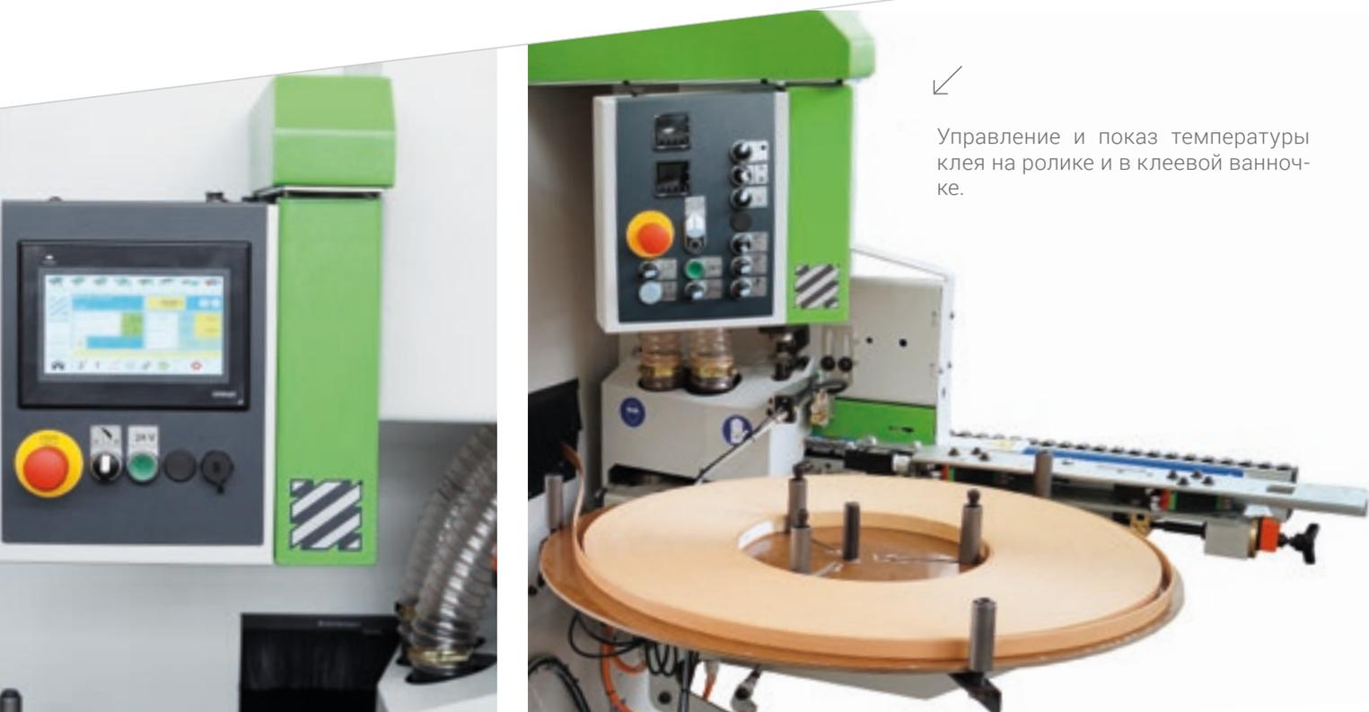
Управление и показ температуры клея на ролике и в клеевой ванночке.
