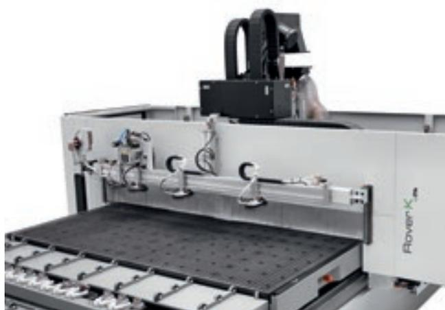
Загрузочный модуль с присосками позволяет автоматически загружать и позиционировать панели на рабочем столе.
