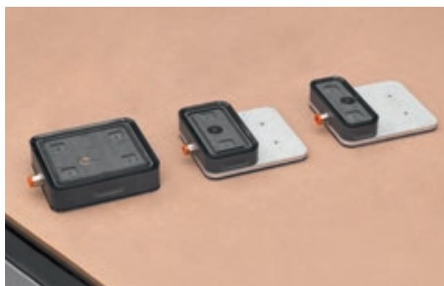
Позиционируемые непосредственно на подкладочной плите вакуумные модули. Модули могут использоваться без вспомогательной вакуумной системы простым и быстрым способом.
