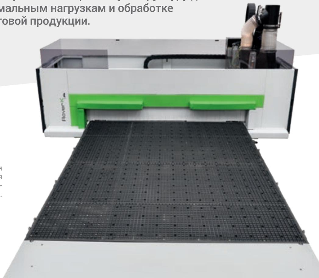
Портальная конструкция с двойным электроприводом разработана для повышения стандартов точности и надёжности при выполнении обработок.
