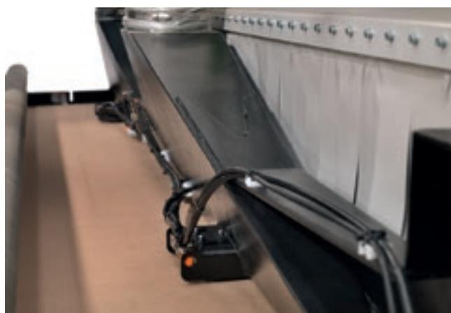
Поворотный выталкиватель с регулируемой лопастью и копирующим приспособлением. Позволяет выгружать плиты с толщиной до 3 мм.
