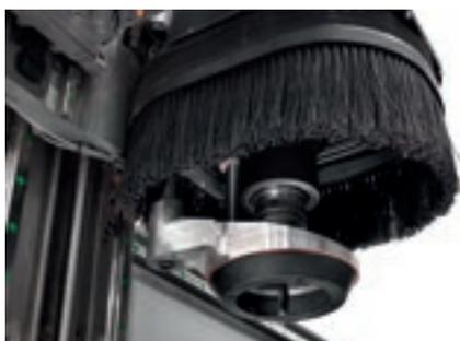
Кольцевое прижимное устройство позволяет осуществлять обработку коробленных и наложенных панелей из пропускающего воздух материала или с высоким уровнем трения, с приложением давления на верхнюю поверхность панели.
