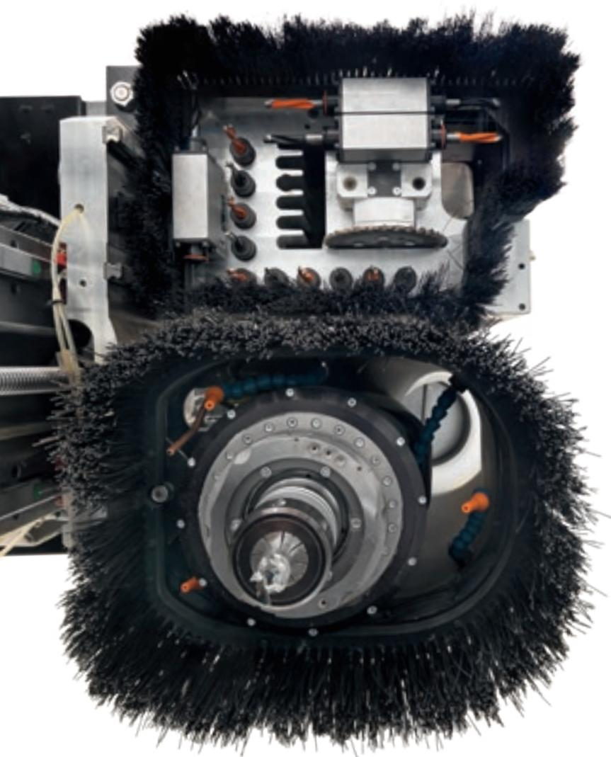
Сокращение времени оснащения станка без ошибок со стороны оператора благодаря Контактному измерителю, который позволяет производить автоматическое измерение длины инструмента.
