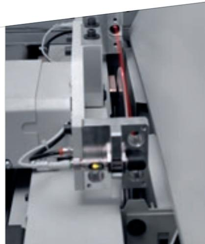
**Автоматическое выравнивание подрезной пилы.** Патентованная система способна автоматически выравнивать подрезную пилу относительно новой основной пилы за считанные секунды. Позволяет сократить время на оснащение, на пробныерезы и на контроль ошибок, увеличивая производительность и снижая затраты на заточку.
