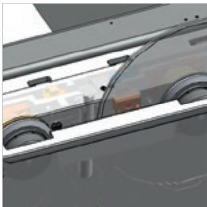
Устройство защиты от перегрузки проверяет положение и скорость вращения пилы, воздействуя на скорость её подачи. **Максимальное качество раскроя, продление срока службы пилы и сокращение стоимости обслуживания.**
