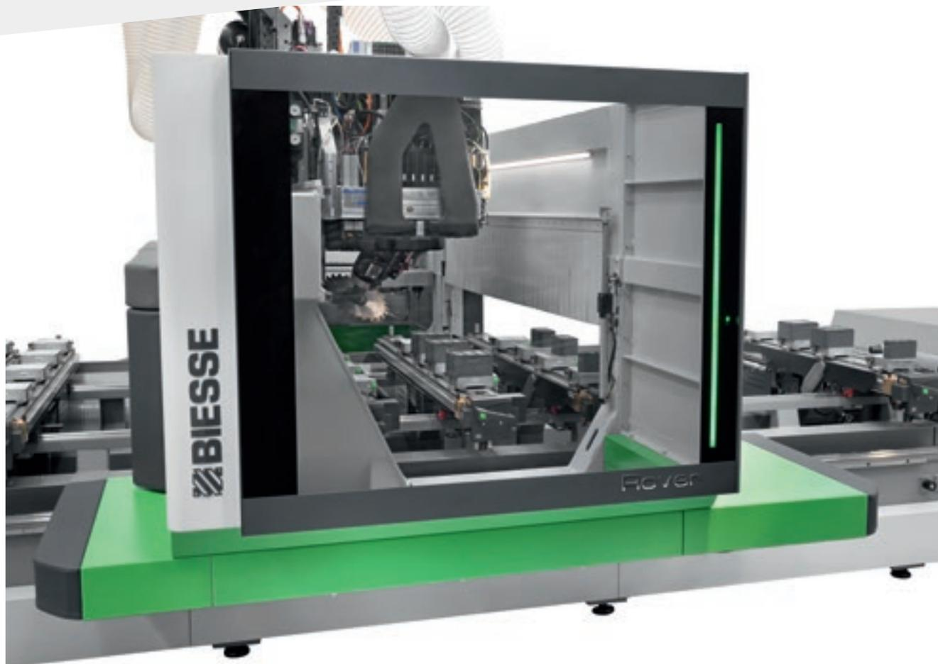
**Внутреннее светодиодное освещение обеспечивает отличную видимость для работы в условиях полной безопасности.**
