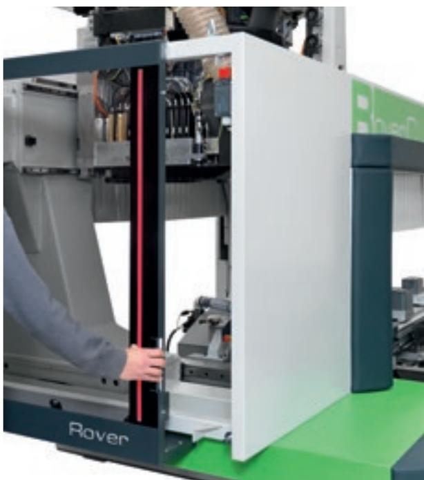
Широкая открывающаяся дверца упрощает доступ при выполнении операций оснащения и очистки с передней стороны.
