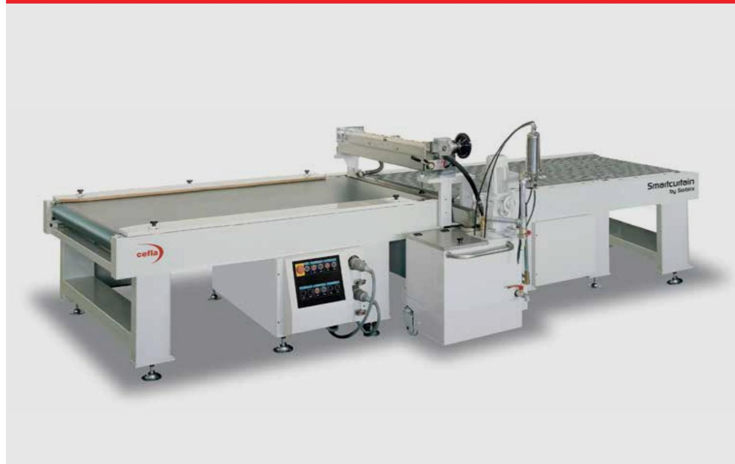
Velatrice adatta alla verniciatura di pacchi di pannelli, con tappeto unico o sdoppiato in entrata per la composizione del piano di carico. Velocità di lavoro regolabili indipendentemente per il carico, velatura e scarico.
