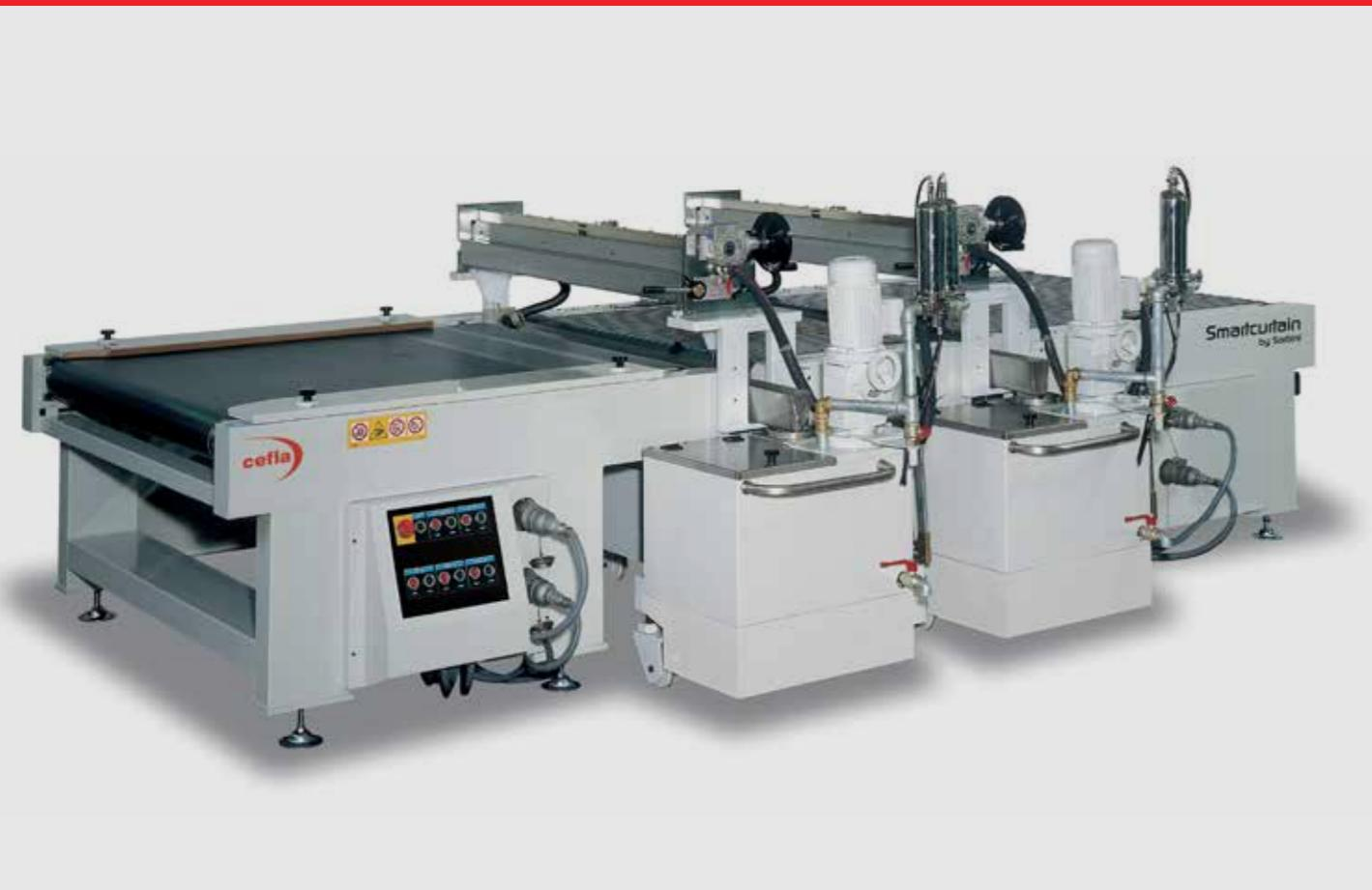
Velatrice adatta ad applicare qualsiasi vernice a varie viscosità. Basamento di acciaio scatolato ad alta rigidità, privo di vibrazioni. Teste estraibili con carrelli completamente staccati dalla struttura della macchina. Tre nastri trasportatori con giuntura vulcanizzata, con velocità regolabile. Serbatoi in acciaio inox. A richiesta, macchina disponibile con due teste fisse.
