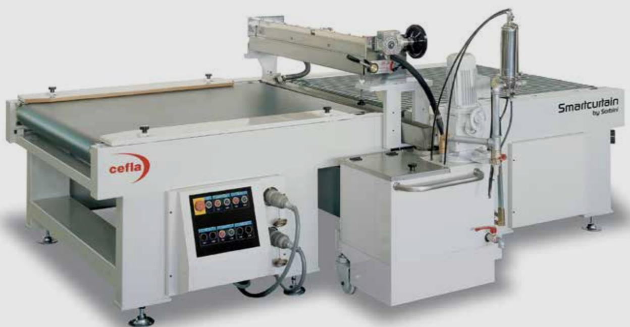
Velatrice adatta ad applicare qualsiasi vernice a varie viscosità. Basamento di acciaio scatolato ad alta rigidità, privo di vibrazioni. Testa estraibile con carrello completamente staccato dalla struttura della macchina. Due nastri trasportatori con giuntura vulcanizzata, con velocità regolabile. Serbatoio in acciaio inox. A richiesta, macchina disponibile con una testa fissa.
