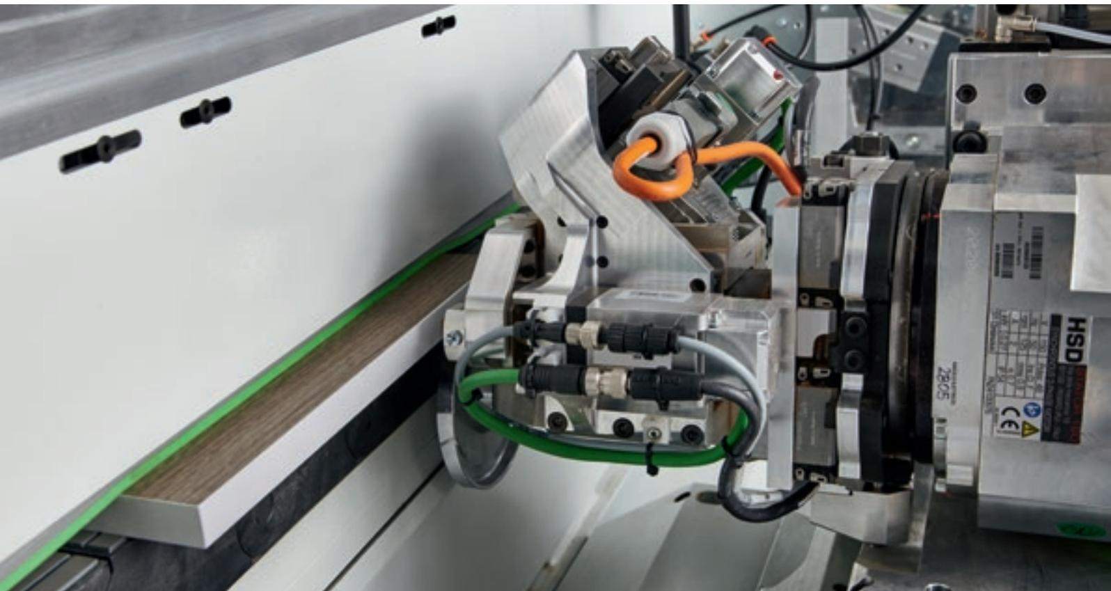
Динамический контроль копирования на панели для обеспечения максимальной повторяемости обработки.
