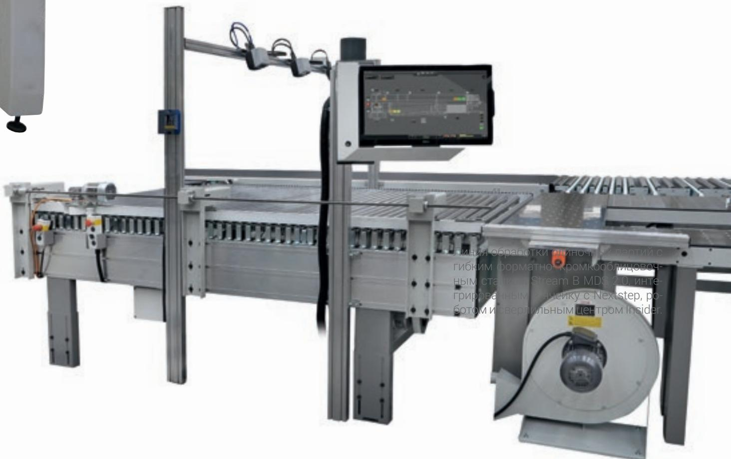
Линия обработки плиточных партий с гибким форматно-кромкооблицовочным станком Stream B MDS 2.0, интегрированным в ячейку с Nextstep, роботом и сверлильным центром Insider.
