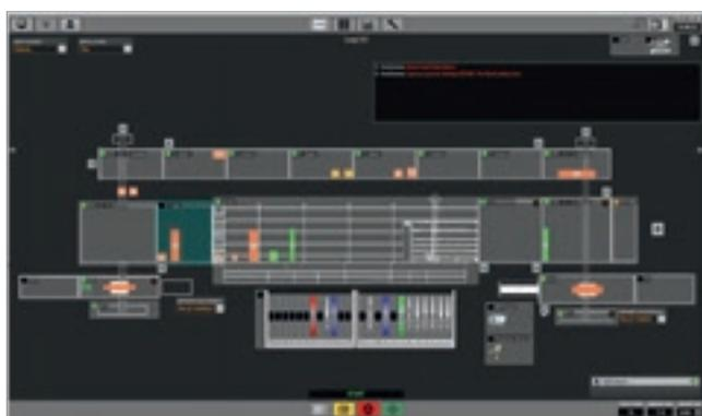
Супервайзер линии управляет потоком материала внутри станка Stream В MDS и позволяет распознавать В РЕАЛЬНОМ ВРЕМЕНИ состояние самого станка, положение и количество панелей и соответствующие рабочие фазы.
