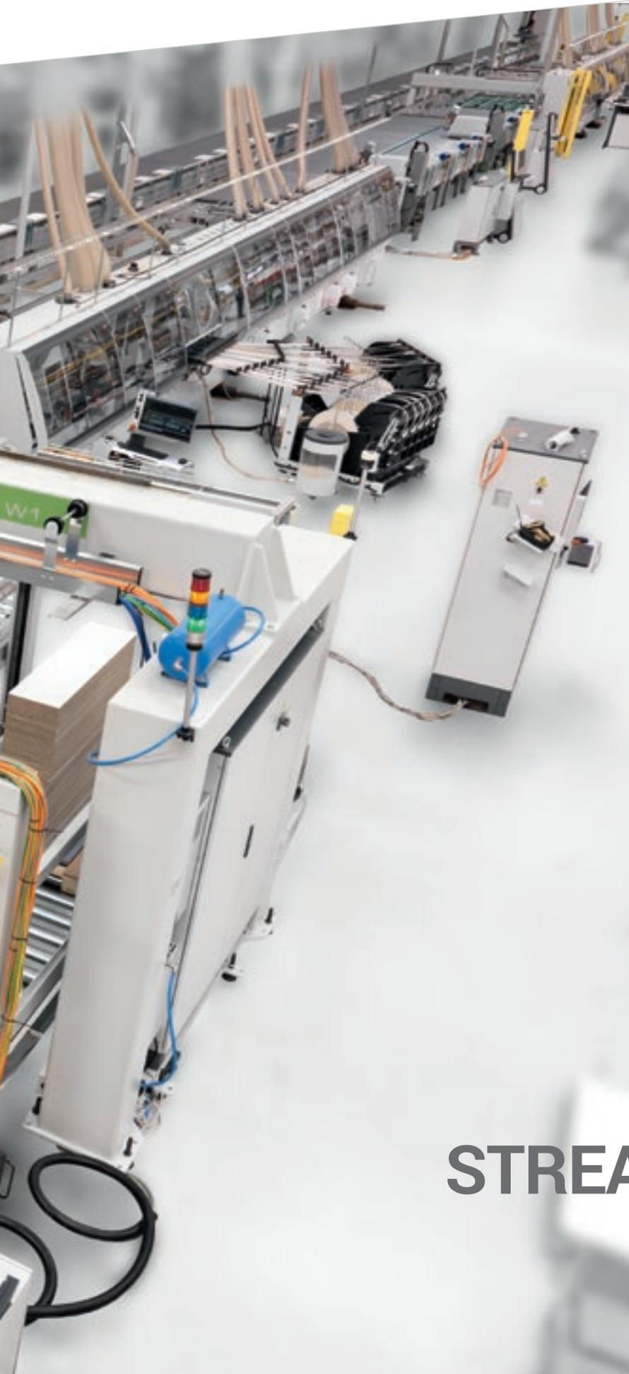
Stream B MDS 2.0 разработан для того, чтобы панели подавались в различных режимах, кроме ручного. Робот, загрузчик или любая другая система подачи легко интегрируются со станком в этой версии.
