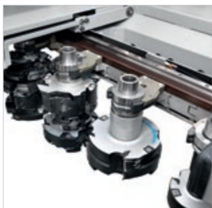
Новая металлическая усиленная цапга для загрузки инструмента до 10 кг.
