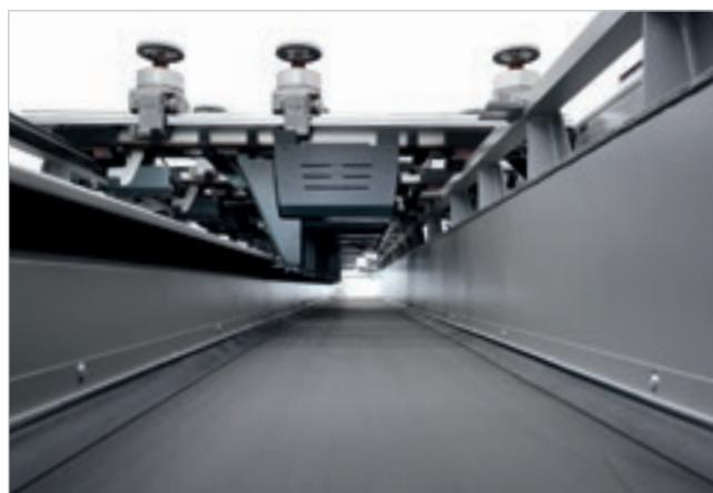
Приводной транспортер для удаления стружек и обрезков.
