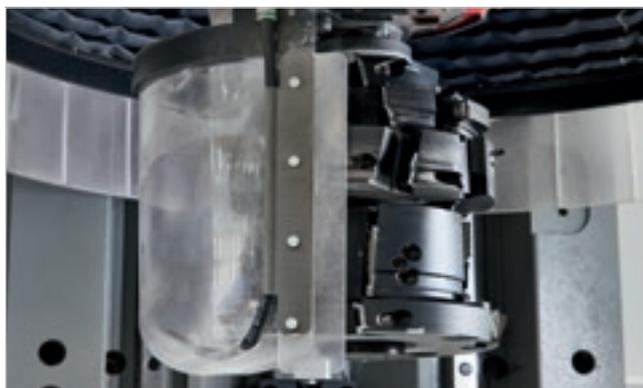
**Дефлектор с форсированным потоком** с встроенной продувкой, увеличивает скорость стружки внутри дефлектора, улучшая очистку станка.
