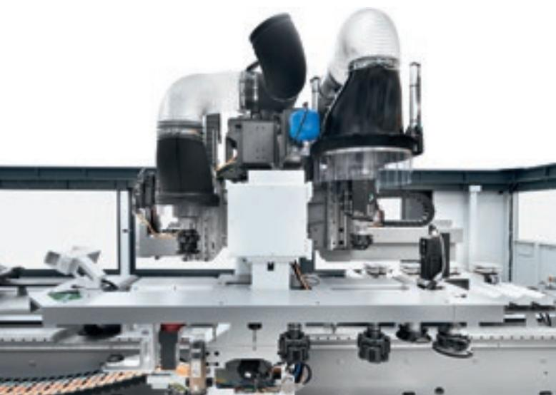
Двойной электрошпиндель позволяет производить все возможные смены инструмента в скрытое время, каким бы ни был цикл обработки. Действительно, два шпинделя, расположенные на двух краях каретки, забирают инструмент из одного магазина: пока один шпиндель работает, второй производит смену инструмента.
