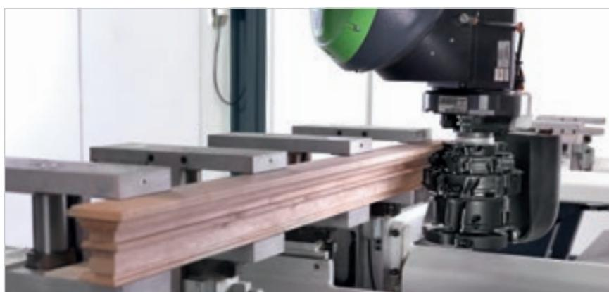
5-осная голова на 16,5 кВт, предназначенная для обработки массива: мощность и жёсткость для исполнения тяжёлых операций.
