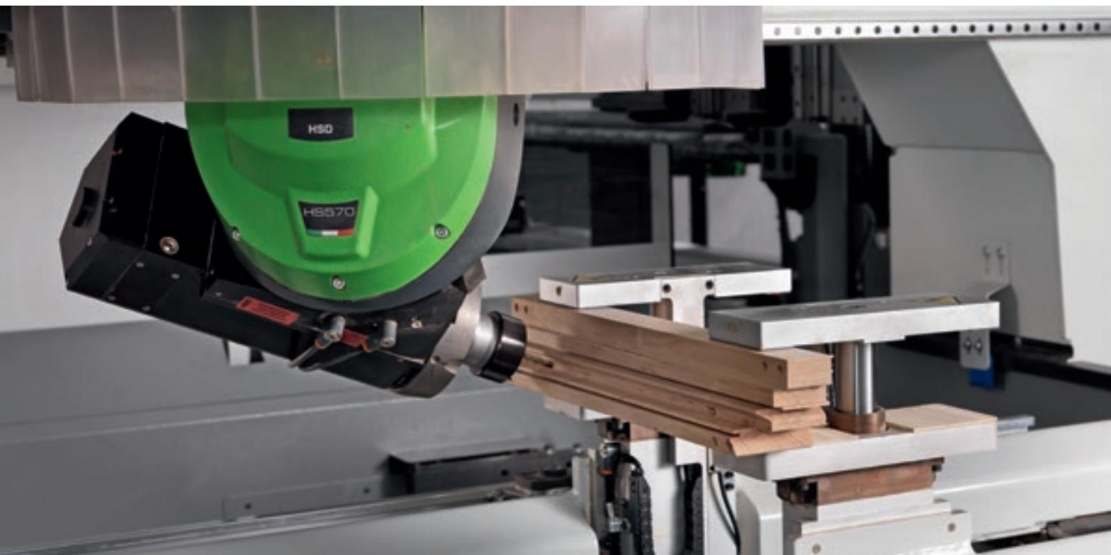
5-осевой фрезерный блок 21,6 кВт является очень мощным и жестким, гарантирует высокую производительность и компактные размеры, обеспечивая высокий стандарт отделки.
