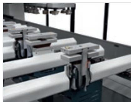
Датчик "Safe Locker" проверяет факт фиксации детали. Это позволяет оптимизировать время цикла и устраняет риск столкновений.
