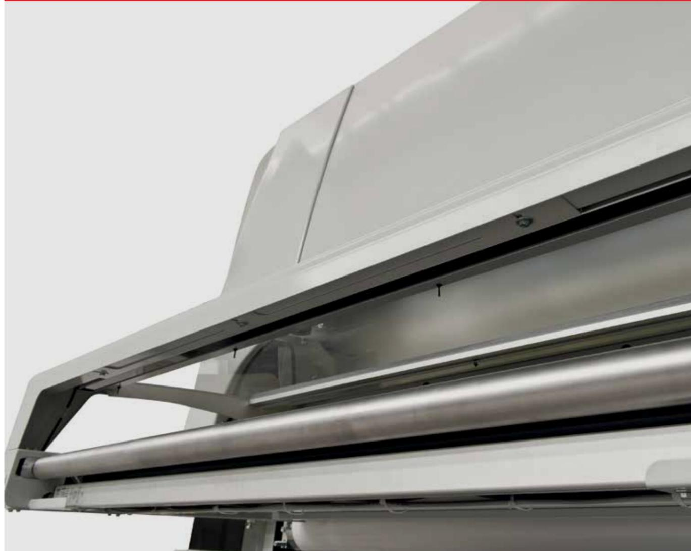
Easy è dotata di una barriera di lettura ad elevata precisione per la scansione dei pezzi in ingresso. I dati sono elaborati dal software di gestione e trasmessi alle pistole per ottimizzare la spruzzatura ed evitare sprechi.
