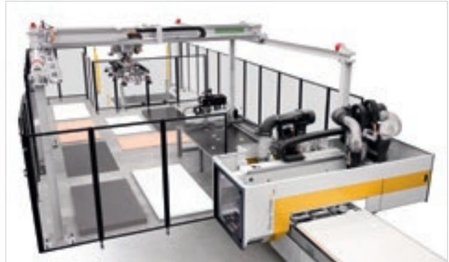
**Winstore** позволяет располагать подлежащими обработке панелями в любой момент без частых смен стоп материала, что значительно повышает производительность ячейки по сравнению с решениями, которые предусматривают загрузку стоп при помощи погрузчика.
