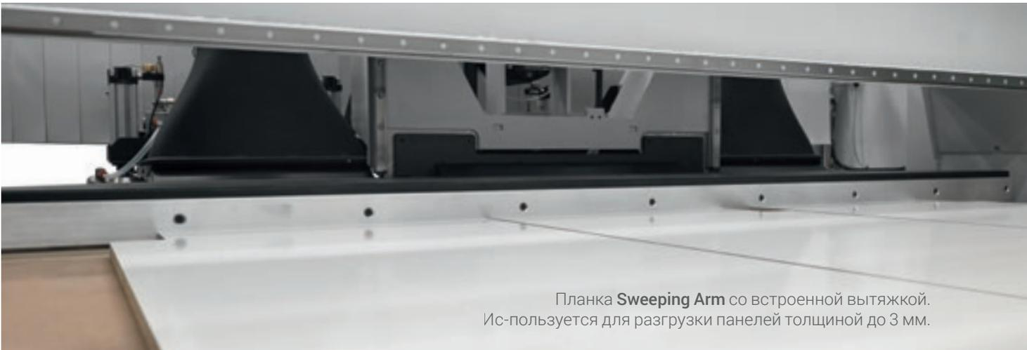
Планка **Sweeping Arm** со встроенной вытяжкой. Используется для разгрузки панелей толщиной до 3 мм.
