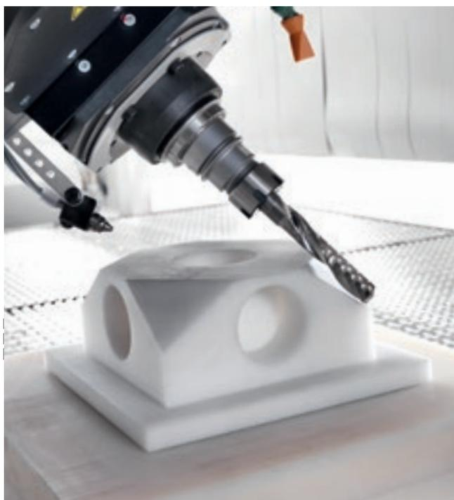
5-осевой агрегат с прямым приводом обеспечивает максимальную гибкость при обработке под углом и с интерполированием, не боясь чрезмерной нагрузки.
