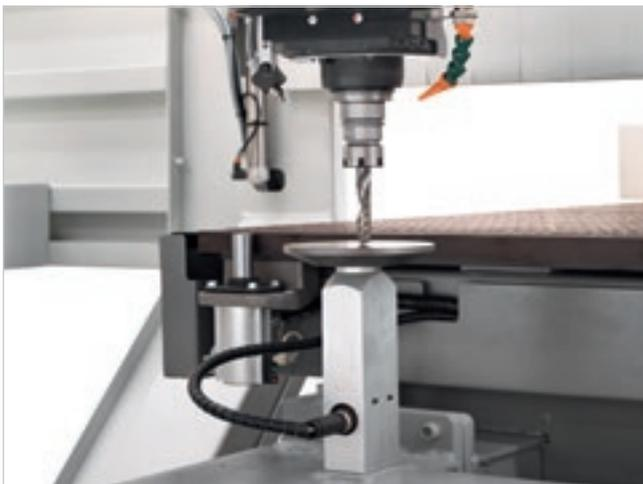
Контактное устройство предварительной наладки позволяет автоматически измерять длину инструмента диаметром до 130 мм. Это позволяет значительно сократить время оснастки станка и исключает возможность ошибок со стороны оператора.
