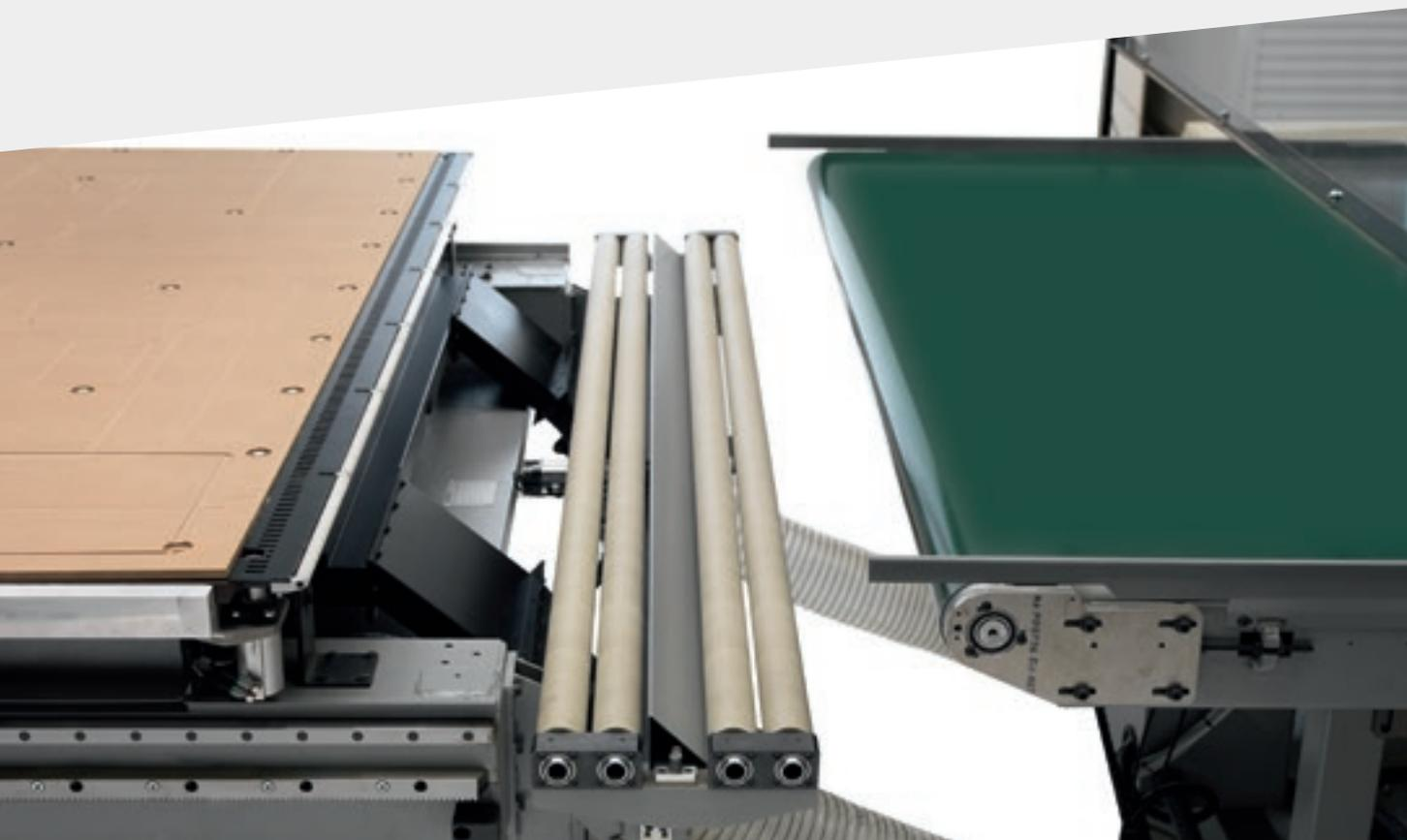
Роликовое прижимное устройство позволяет осуществлять пакетную обработку воздухопроницаемых материалов с наложенными друг на друга панелями. Его совместимость со всеми конфигурациями с двойными группами значительно увеличивает производительность.
