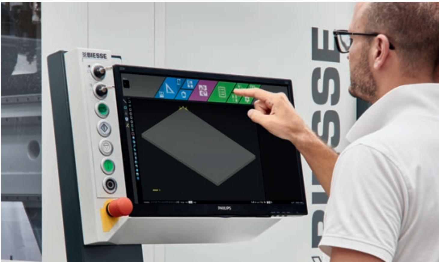
**bTouch - это новый сенсорный экран 21,5", позволяющий выполнять все функции, выполняемые мышью и клавиатурой, обеспечивая прямую интерактивность между пользователем и устройством.**
