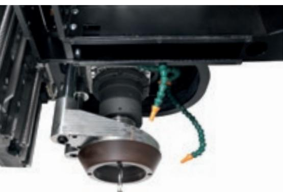
Кольцевое прижимное устройство позволяет осуществлять обработку коробленных и наложенных панелей из пропускающего воздух материала или с высоким уровнем трения, с приложением давления на верхнюю поверхность панели.
