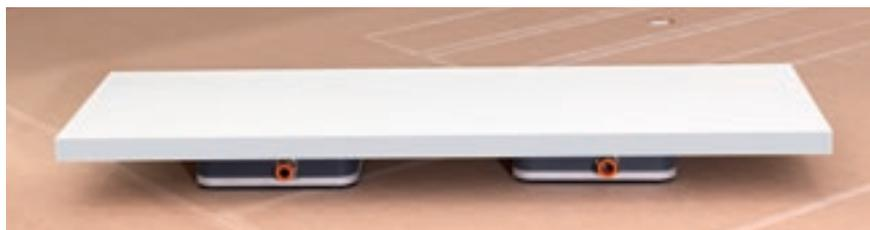
Позиционируемые непосредственно на подкладочной плите вакуумные модули. Модули могут использоваться также и без вспомогательной вакуумной системы простым и быстрым способом, не сказываясь при этом на удержании панели.
