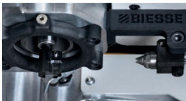
**Система смазки инструмента для режущего блока** обеспечивает лучшее скольжение пилы в особо плотных или эластичных материалах благодаря системе распыления воздуха-масла, обеспечивающей смазку инструмента во время резки.
