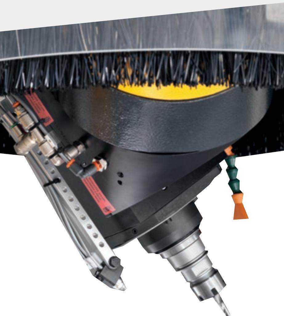
Rover Plast A FT несёт на себе те же компоненты, которые используются на станках более высокой гаммы. Электрошпиндель и агрегаты спроектированы и выполнены для Biesse подразделением HSD, предприятием, являющимся мировым лидером в данном секторе.
