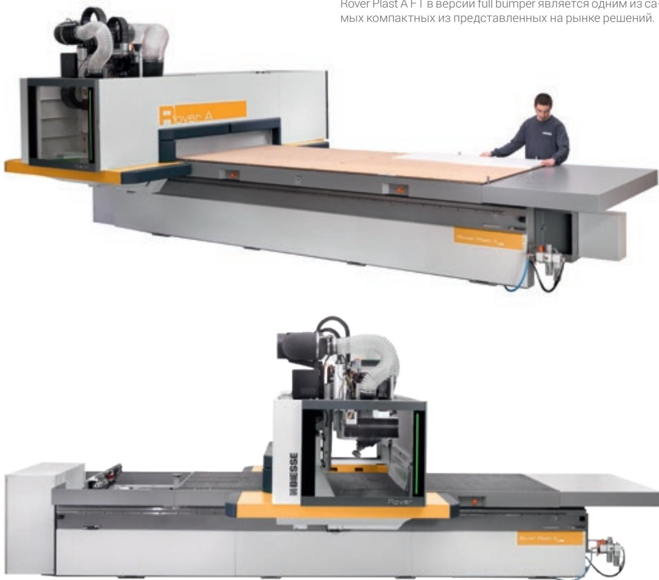
Решение full bumper предназначено для оптимальной адаптации производственному пространству. Позволяет оператору всегда иметь доступ к станку со всех сторон, в условиях полной безопасности и без наличия препятствий.
