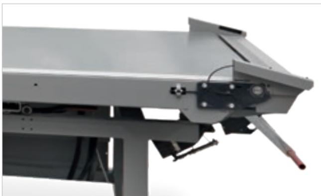
Всасывающий коллектор расположен в конце ленточного транспортера.
