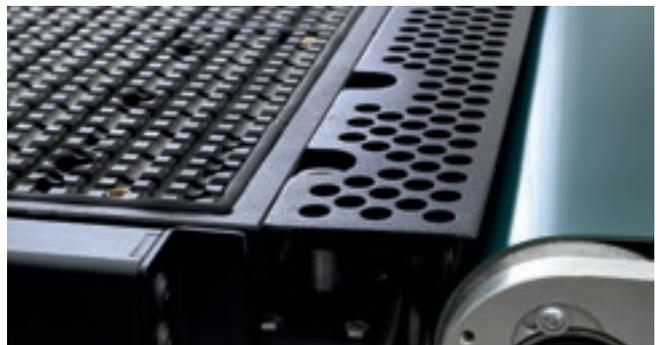
Система вытяжки стружки между станком и ленточным транспортером выгрузки, обеспечивает максимальную очистку деталей.
