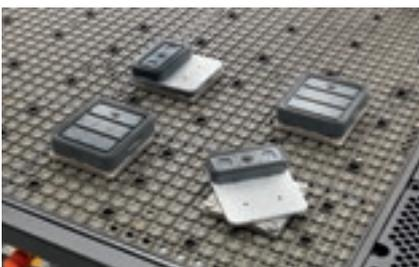
Модули FT с алюминиевым адаптером. Поверхность FT PLUS упрощает размещение модулей, обеспечивая максимальную стабильность.
