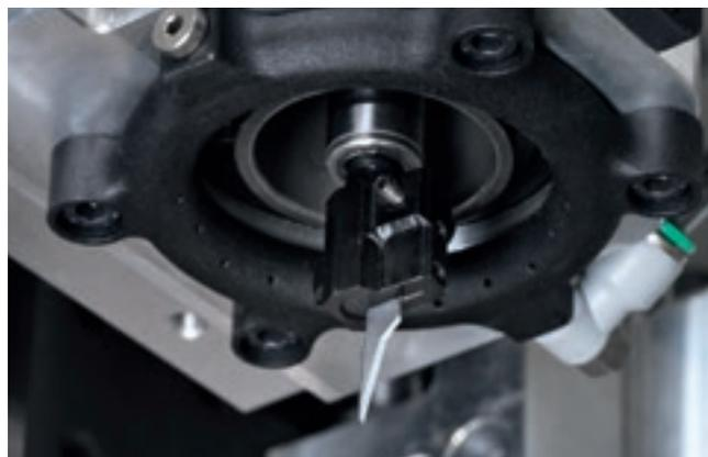
**Устройство воздухоудвки для режущего блока** позволяет уменьшить перегрев пилы и, как следствие, повреждение некоторых видов материалов, одновременно обеспечивая очистку зоны резки от пыли и других отходов обработки.
