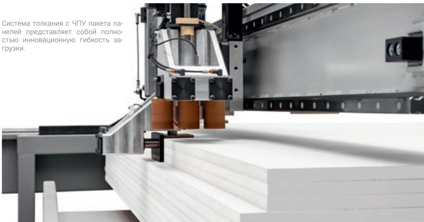
Запатентованная система загрузки с помощью зажимов позволяет загружать пакеты панелей или панелей с высокой воздухопроницаемостью, которые, в противном случае, перемещать с помощью присосок становится сложно.
