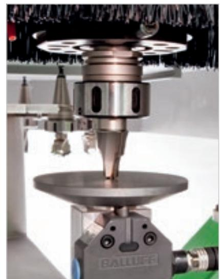
Сокращение времени оснащения станка без ошибок со стороны оператора благодаря контактному измерителю, который позволяет производить автоматическое измерение длины инструмента.
