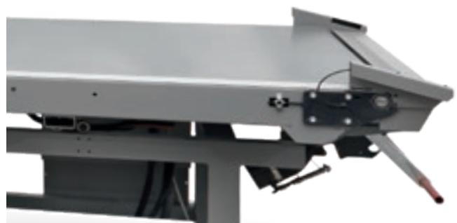
Всасывающий коллектор расположен в конце ленточного транспортера.
