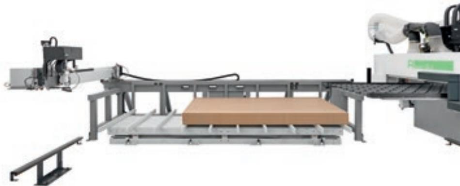
**Система загрузки панелей с ножничным подъёмником и автоматическим выравниванием панели.**
