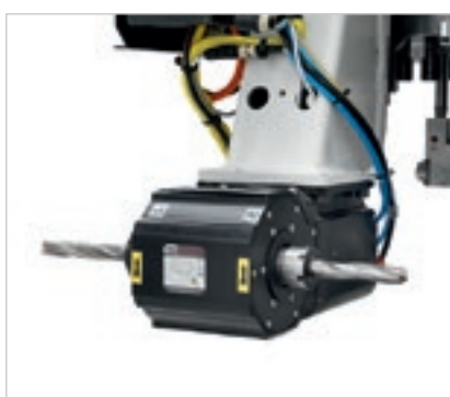
Горизонтальный двигатель с 2 выходами предназначен для выполнения выборки под замок и горизонтальных обработок.
