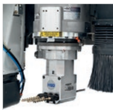
Многофункциональная группа , непрерывно позиционируемая на 360° под управлением ЧПУ, может принимать агрегаты для исполнения специфических обработок (вырезы под замок, посадочные места под петли, глубокое горизонтальное сверление, торцевание и т. п.).
