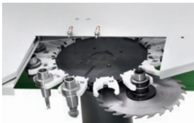
Инструментальный магазин револьверного типа на 13 или 16 мест.
