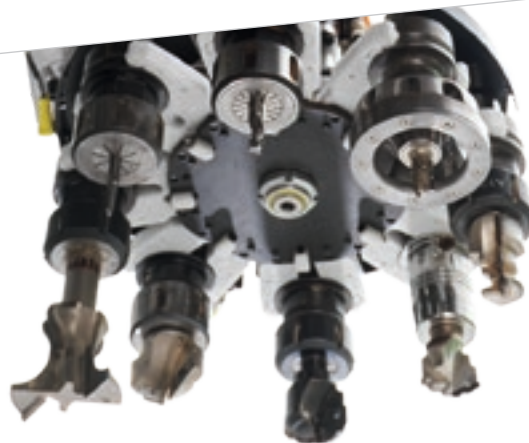
Инструментальный магазин револьверного типа на 8 мест.
