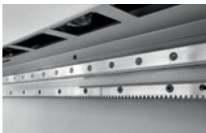
Увеличенные направляющие зубчатых реек и шестерни для движения по осям X и Y для достижения максимальной скорости и ускорения в этой категории, придают обрабатываемому центру большую стабильность во время движений, увеличивая уровень точности и качества обработки.
