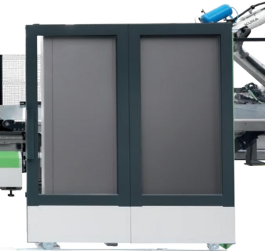
Кабина, в которой находится сам станок, оборудована дверцами, которые можно полностью открыть спереди для облегчения выполнения ручных операций. Большие смотровые окна обеспечивают непосредственную видимость и прямой контакт между оператором и обрабатывающим центром.
