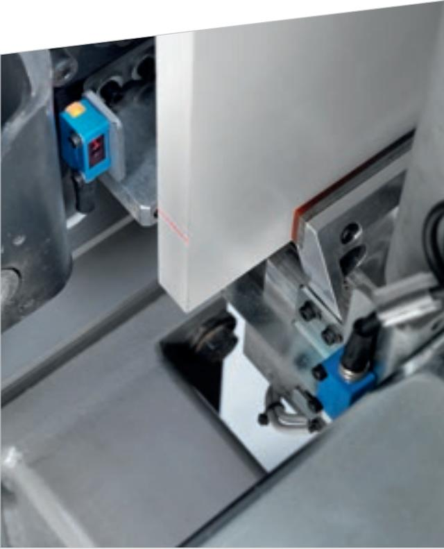
Система **лазерного считывания** служит для считывания начала и конца панели, что позволяет станку компенсировать размерные ошибки с коррекцией координат панели по X.
