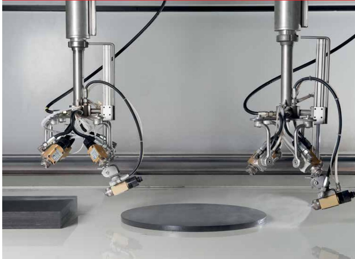
A carico fermo, il quinto asse permette a iBotic di esprimere il massimo delle sue prestazioni in termini di flessibilità, grazie alla possibilità di verniciare i bordi dei pezzi, anche con differenti spessori.
