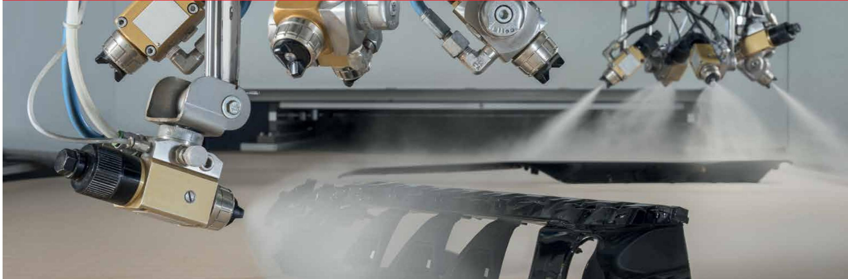
ITALIA In modalità di spruzzatura oscillante, grazie alla possibilità di lavorare con il carico in movimento, iBotic offre il massimo delle sue prestazioni in termini di velocità.
