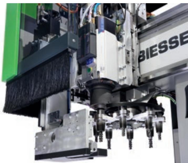
Оснащенный двойным агрегатом с 2 независимыми электрошпинделями и возможностью обработки двух наложенных панелей, обеспечивает повышение уровня производительности.
