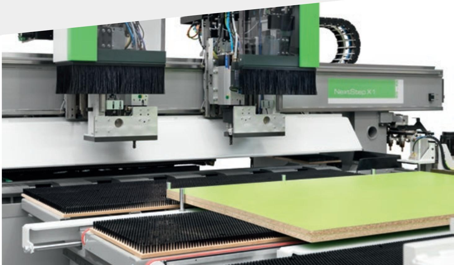
**Жесткая конструкция Nextstep гарантирует отсутствие вибраций в процессе обработки для получения идеальных готовых изделий.**
